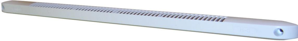
L'entrée d'air autoréglable ajustable Série **M-G** débit de base 15 m<sup>3</sup>/h ou 45 m<sup>3</sup>/h (sous 20 Pa) installée à l'intérieur du logement est associée à un capuchon ou une grille de façade. Elle est équipée de cales sécables permettant d'obtenir un débit jusqu'à 30 m<sup>3</sup>/h pour la **M-G 15**.
