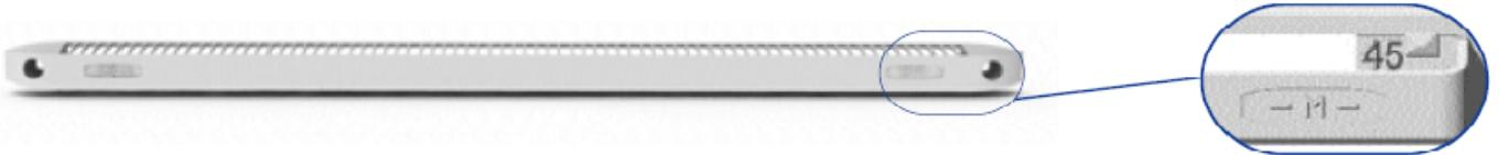
Entrées d'air **M-G 15, 22 & 30 m3/h** : ces entrées d'air sont stockées au débit de 15 m3/h. Sur chantier, lors de la pose, adapter le débit selon nécessité. Pour les grandes commandes, livrées avec le débit demandé 15, 22 ou 30 m3/h. Le débit est indiqué sur les 2 clips de maintien de l'élément régulateur (15, 22 et 30 m3/h).
