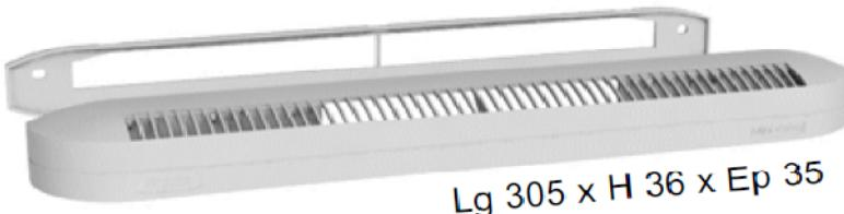
**Attention :** L'entrée d'air ESEA mini 30 m3/h se pose uniquement sur l'entaille 250 x 12 mm
